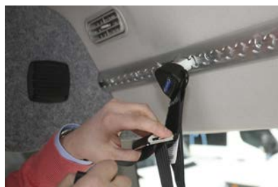
I taket sitter ett skensystem där man med ett fäste och snabbkoppling kan placera säkerhetsbältet var man vill. Det gör att man kan placera rullstolen på valfri sida i färdtjänstbussen.
