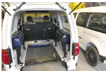
Golvet sänks med fem centimeter i det klassiska Caddy-konceptet.
