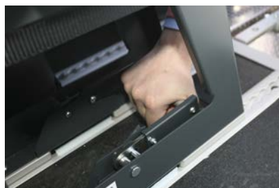
Stolsbenen är unika i det nya konceptet. Genom att lyfta handtaget plockar man enkelt bort stolen och kan placera den var man vill i bussen.
