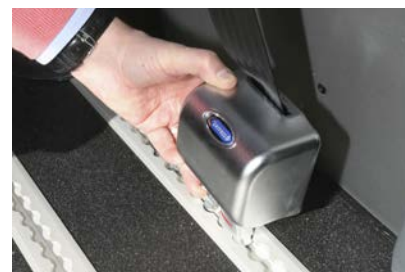
Med snabbkopplingen fäster man säkerhetsbältet var man vill i golvets skensystem.
